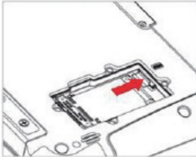
8. 3G/LTE モジュールを元の位置に戻し、ネジで固定する
