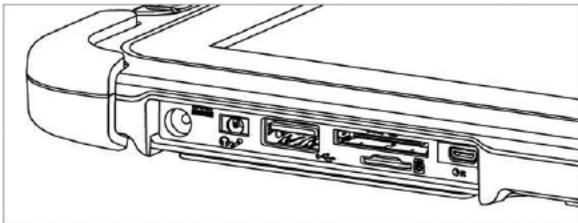
2. 電源アダプターのコネクタを、本機の電源コネクタに差し込む
