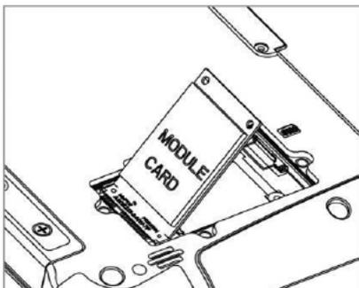
6. Micro SIM カードの端子面が下、ノッチが挿入方向（右方向）にあることを確認する
