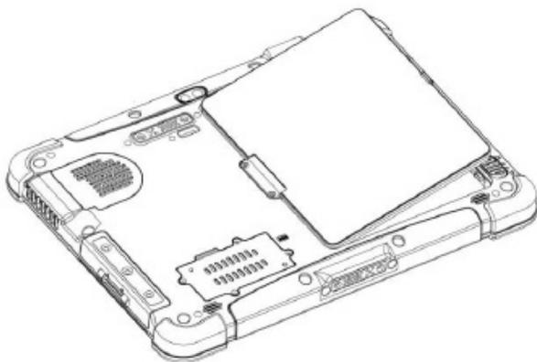
5. バッテリーがバッテリー格納部に完全に取り付けられている（本体とバッテリーが平坦になるように取り付けられている）ことを確認し、バッテリーリリーススライダーを離す
