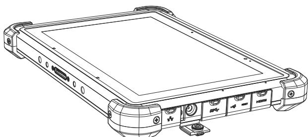
2. 電源アダプターのコネクターを、本機の電源コネクターに差し込む
