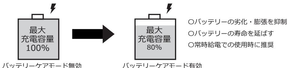
バッテリー搭載のタブレット製品を AC アダプターから常時給電状態で連續使用しますと、バッテリーの劣化が早くなる場合があります。その場合、本案内のバッテリーケアモードを有効の状態で使用することをお薦めします。
