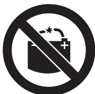
● バッテリーのプラス (+) とマイナス (-) を金属などで接触させないでください。濡らしたり、ネックレス・ヘアピンなどの金属と一緒により持ち運んだり保管するとバッテリーの端子が接触し、感電・液漏れ・発熱・発火・破裂の原因となります。
