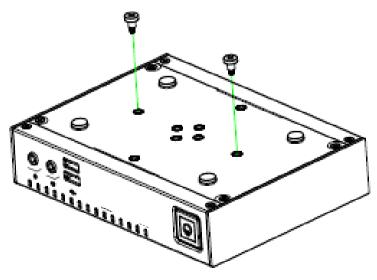
付属の VESA 金具を固定用ネジ (M4 × 6) でモニターに取り付けます。 ( 推奨トルク値: 0.98N・m)
