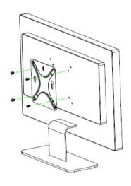
本体底面に取り付けられたネジを VESA 金具の穴に引っかけるようにして 本体を取り付けます。
