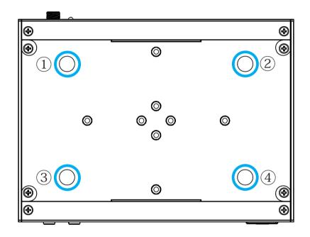
添付のネジ (M3 × L11.1) を2つ、本体底面のネジ穴に取り付けます。 ( 推奨トルク値:0.49N・m)
