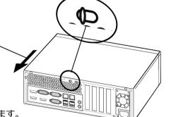
④カバーを取り付ける場合は、カバークリップを押したまま、左側面カバーを前面側にスライドします。
