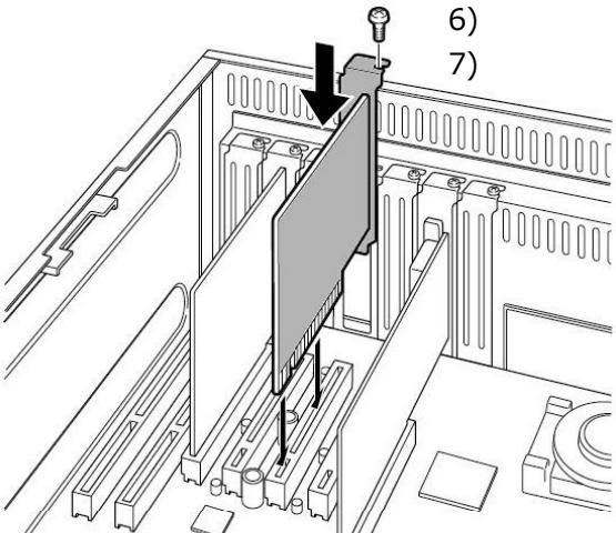
8) 拡張ボード押さえバーを元に戻し、2) のネジで固定します。
